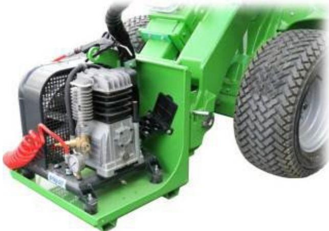
Kompresor je umístěn na čelní desce, je poháněn přídavnou hydraulikou a je schopen dodat 400 litrů/min při 8barech. Je vhodný pro pohon ručního náradí, čištění, obsluhu pneumatik apod.
