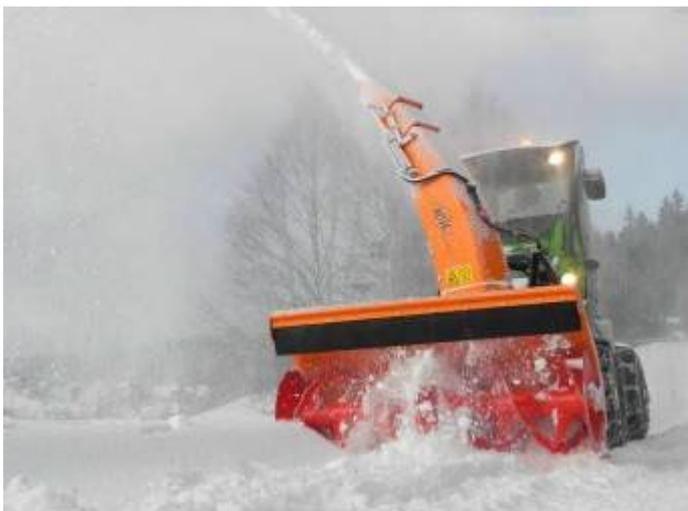
**Oddělené ovládání rychlosti pojezdu od otáček motoru** = možností maximálního průtoku na hydraulice již při rychlostech 1 metr za hodinu
