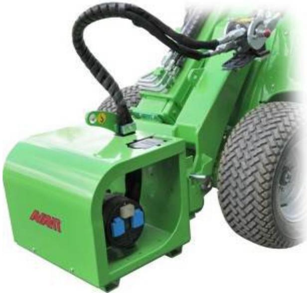
Elektrocentrála je dostupná v jedné velikosti 6,5 kVA. Model je třífázový (2x230V a 1x400V). Elektrocentrála je poháněna z přídavné hydrauliky nosiče a je ideální jako zdroj energie v místech, kde prodlužovací kabel je již problém. Může být umístěna vpředu na desce anebo vzadu nad motorem na pomocném rámu. Tento rám lze odklopit kvůli zachování servisního přístupu k motoru. Zadní montáž nelze u AV200,300 a R.
