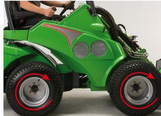
Antislip ventil u hydrostaticky poháněných strojů nahrazuje uzávěrku diferenciálu. Ovládání je elektrohydraulické.
