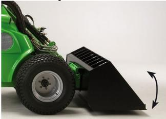
Elektricky spínaná plovoucí poloha ramene a desky. Tlumič rážů i plovoucí poloha nejde použít samostatně, pouze ve spojení obou příslušenství.
