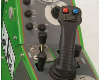
Rozšíření standardních funkcí joysticku o další 2 páry ovládané tlačítka a kolíčkem – elektromagneticky. Ovládání třetí funkce a paralelogramu. U modelů 600,700 a 800 je ve standardu. Ovládání nářadí a teleskopu.
