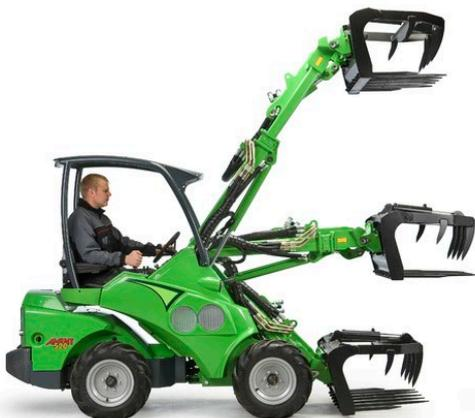
paralelogramu je navíc zvedací síla při zvedání větší. Hydraulický válec paralelogramu pomáhá zvedat břemeno.
