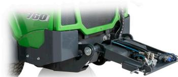
Zadní upínací deska je zařízení umožňující agregaci sypače A424325. Díky tomuto je sypač samo nakládací. Montováno na zadní části nakladače Avant – místo zadního závaží 170 kg. Pokud je potřeba zvedat maximální zvedací kapacitu 1500 kg – je potřeba stroj dotížit. Sklopení od svislé polohy – 95°. Hydraulické zámky, jež zaručují svislost desky i během jízdy.
