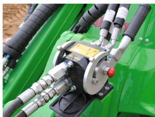
Nové připojení přídatné hydrauliky pomocí bezodkapových rychlospojek umístěných v mechanismu s možností snadnějšího připojení v těžších podmínkách
