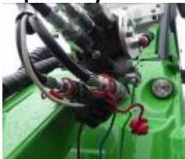
Přídavný přední dvoučinný hydraulický okruh. Elektrická zásuvka na přání.
