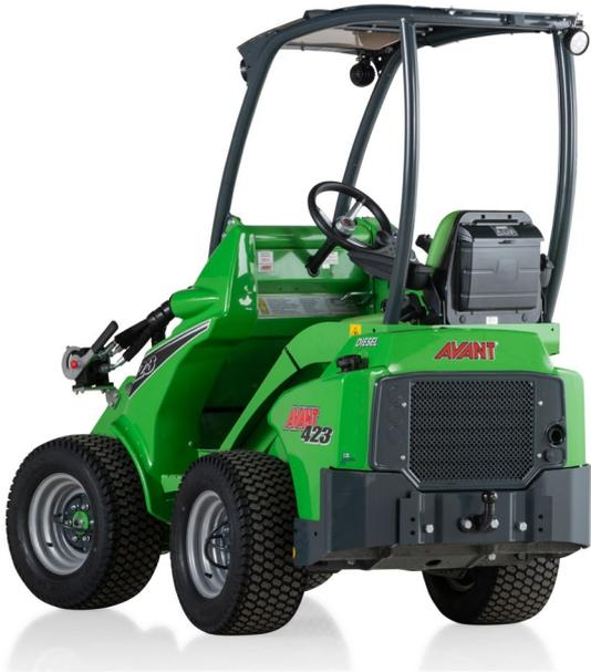
**Bezpečnostní rám - ROPS** - standardní vybavení stejně jako kryt ze zabarveného plexiskla – konstrukce je tvořena ze čtyř sloupků. Jde o opatření pro zvýšení bezpečnosti pro případ pohybu vzad, nebo nárazu do objektu. Rám ROPS a volitelný kryt FOPS byl podroben testům, na jejichž základě získal certifikát ISO.
