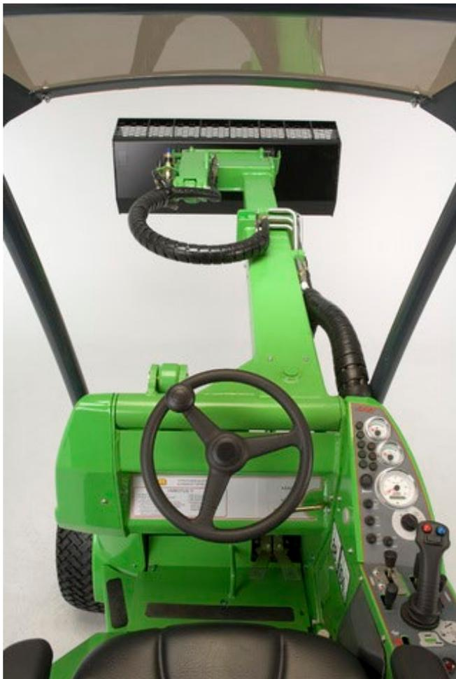
**Excentrická konstrukce ramene** - Pravostranný design zvedacího ramene a nižší konstrukce přední části stroje zaručují neomezený výhled na pracovní nářadí.
