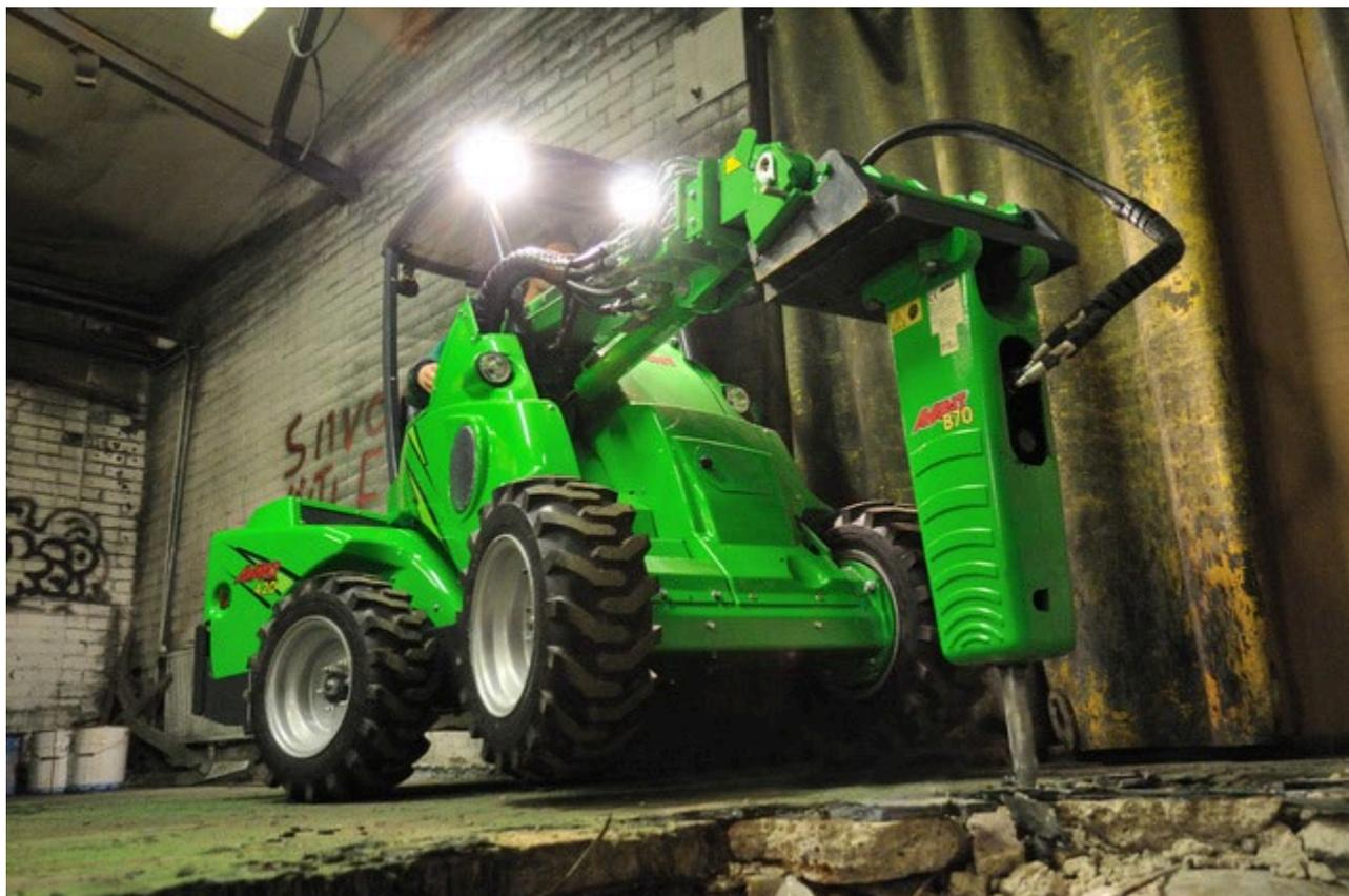
Nakladače Avant se umí velice dobře pohybovat uvnitř objektů a díky možnosti agregace například bouracího kladiva jsou tyto stroje vhodné k demoličním a vyklízcím pracím. Domíchávání betonu, manipulace s paletami, vrtání děr a lehčí zemní práce – to je jen malý výčet dalších možných uplatnění strojů Avant.
