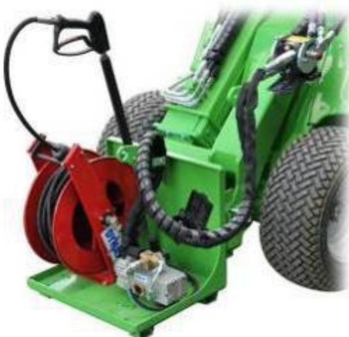
Tlaková myčka je opět poháněna přídavnou hydraulikou a je schopna dodat výkon 30 litrů vody při 200 barech. Na samonavíjecím bubnu je umístěno 30 metrů hadice s pistolí. Sací výkon je do 3 metrů pod úroveň agregátu.
