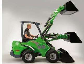
Vyrovňování naklonění nářadí s podkladem. Paralelogram je hydraulický nebo mechanický u série 200.
