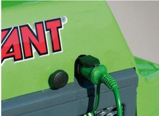
Volitelné příslušenství. Topná spirála vsazená do bloku hlavy. Pomáhá ohřát elektrickým proudem (220V) motor v horších klimatických podmínkách.
