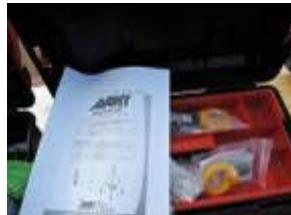
Sada řetězů a upnutí určená pro zvedání Avanta za střechu kabiny LX/DLX jeřábem.
