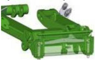
Zamykání nářadí na desce pomocí hydraulického válce, ovládaného z kabiny obsluhy.
