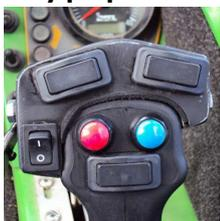
Přídavný blok rozšiřuje možnost elektrického ovládání dalších funkcí. Instaluje se jako rozšíření joystiku. Je nutný pro elektrické ovládání nářadí – pokud jej vyžaduje – je to u něj uvedeno.
